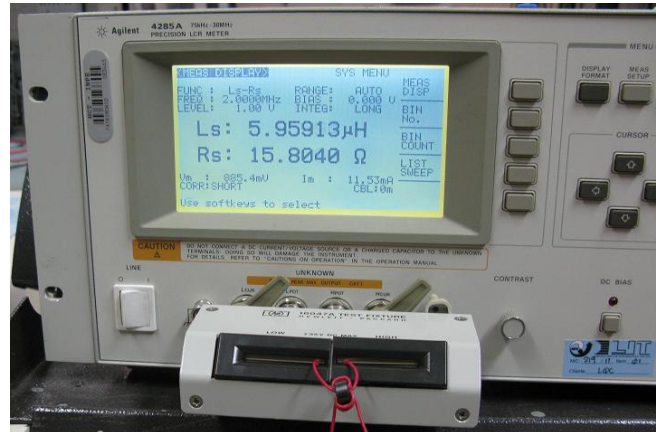
Figura 3.14 - Set-up da medição da indutância do toróide pela frequência.
