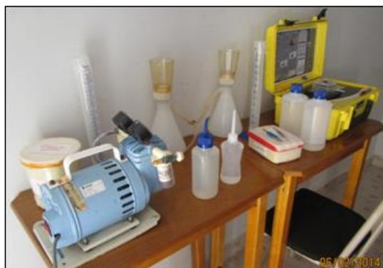
Figura 4.11 - Utensílios utilizados na filtração.
