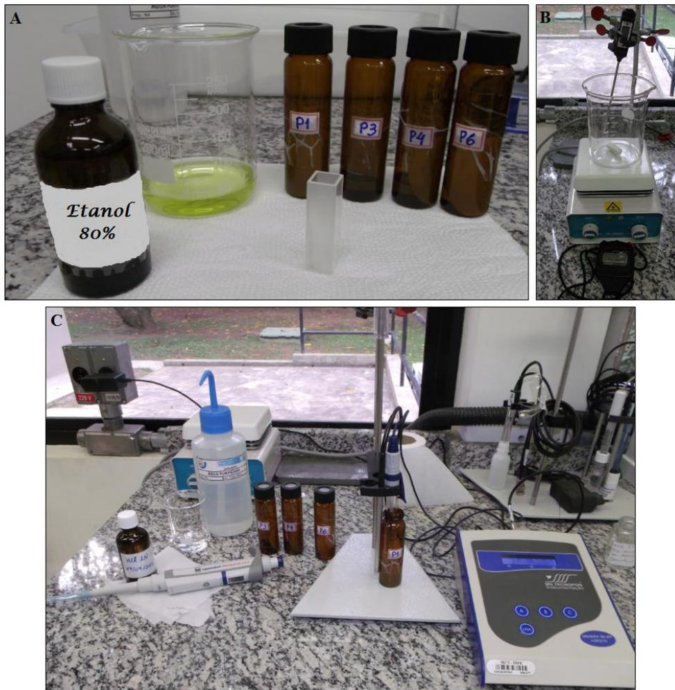
Figura 4.14 - (A) Extração da clorofila com etanol 80% e cubeta usada na leitura, (B) equipamento utilizado para o banho maria e (C) acidificação da amostra de clorofila extraída.
