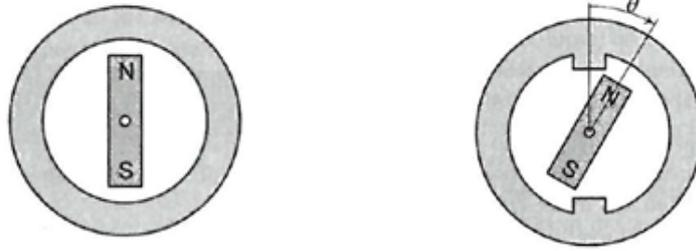
(a) Ímã girando livremente dentro de um anél ferromagnético.
