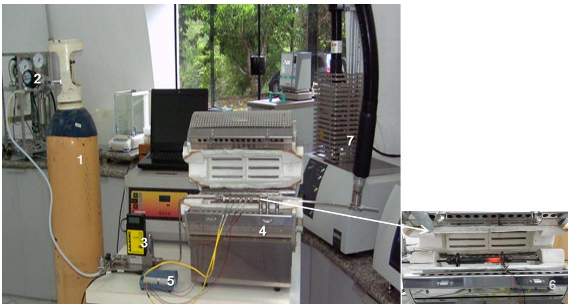
Os catalisadores foram avaliados em um reator de aço inoxidável de 15 mm de diâmetro interno e 60 mm de comprimento, carregado com cerca de 7 g do material catalítico. O reator foi inserido no forno elétrico disposto na posição horizontal. O fluxo do propelente foi ajustado com auxílio de um medidor
