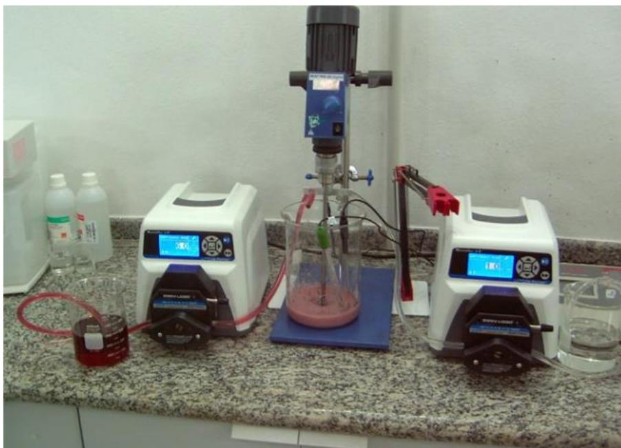
O precipitado formado permaneceu em envelhecimento por 24 h, seguido de filtragem a vácuo, lavagem com água deionizada a temperatura ambiente até pH neutro e secagem em estufa a 383 K, por 12 h. A amostra foi triturada e peneirada a uma granulometria inferior de 0,15 mm. Neste procedimento foram obtidos catalisadores de Co:Mn:Al nas razões molares 1:0:2; 0:1:2; 1:2:0; 2:1:0; 1:4:1 e 4:1:1 denominados 1Co2Al; 1Mn2Al; 1Co2Mn; 2Co1Mn; 1Co4Mn1Al e 4Co1Mn1Al, respectivamente.
