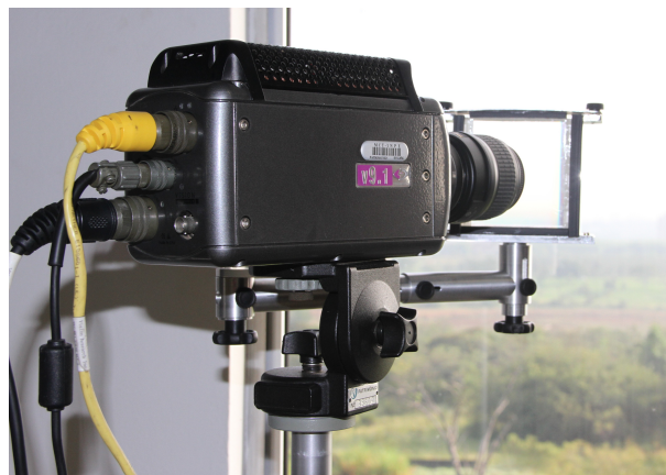
Figura 3.3 - Sistema câmera- grism .
