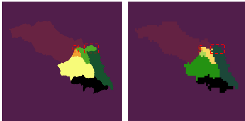
Figura B.30 - Incompatibilidade entre as resoluções alta e baixa na delimitação das sub-bacias.
