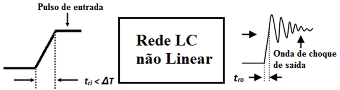
Figura 2- Processo de geração de onda de sóliton em uma LTNL.
