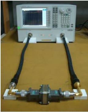
Fig. 3. Montagem experimental completa para medição dos parâmetros de espalhamento.
