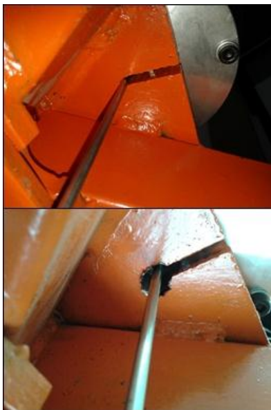
Figura 7. Detalhe da passagem da haste pelo orifício, cujo contato causava vibrações indesejáveis, e, portanto, foi corrigido.
