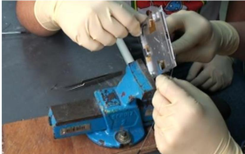
[P-ANT-5] Enrolar o fio mais longo na estrutura. Passar o fio no orifício da lateral do mecanismo de antenas passando pela resistência, passar fio no orifício da placa de alumínio e prender com Kapton no lado da saída do fio. Repetir este procedimento com todos os fios, na ordem decrescente.
