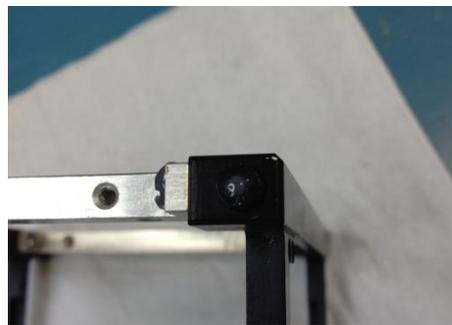
[P-MI-29] Colar com Epóxi a placa de alumínio  $+Y$  com o mecanismo de antenas (mecanismo aberto), aplicando pouca quantidade de cola nos pontos de contato entre as duas partes. Aparafusá-los na estrutura para manter o posicionamento correto durante a cura do Epóxi.
