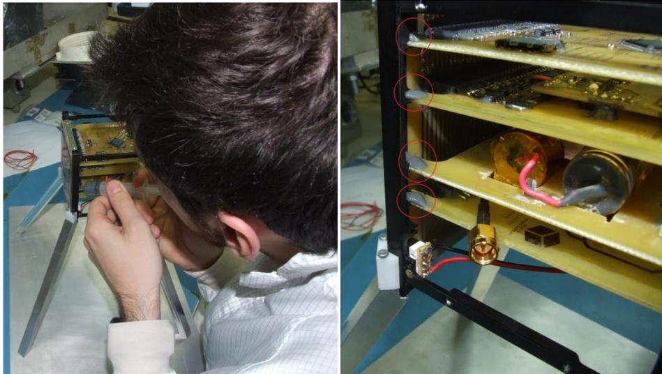
[P-MI-23] Aplicar torque de 1N/m nos dois parafusos internos M3 da PCB do umbilical (que já está acoplada no EPS). Selar os mesmos com Epóxi.
