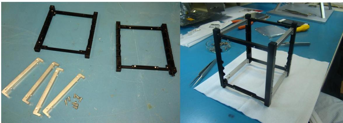
[P-MI-5] Aplicar o torque de 0,5N/m nos 8 parafusos e verificar principais dimensões ( $X=Y=100\text{mm}$  e  $Z=113,5\text{mm}$ ).
