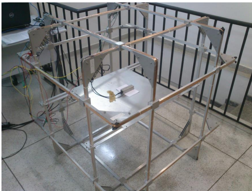
Figura 4.1 – Sensor AHRS alinhado com os eixos de simetria do conjunto de bobinas.
