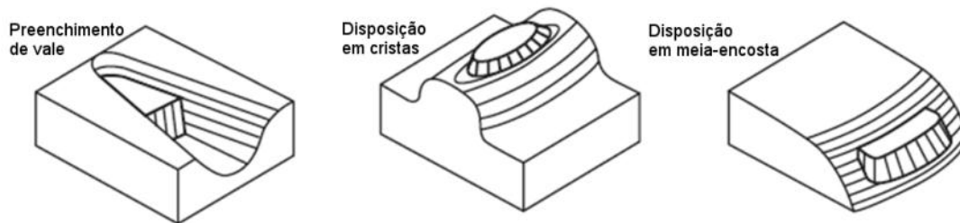
Figura 2.52 – Configurações básicas de pilhas de estéril com base na topografia local. Adaptado de Orman et al. (2011).
