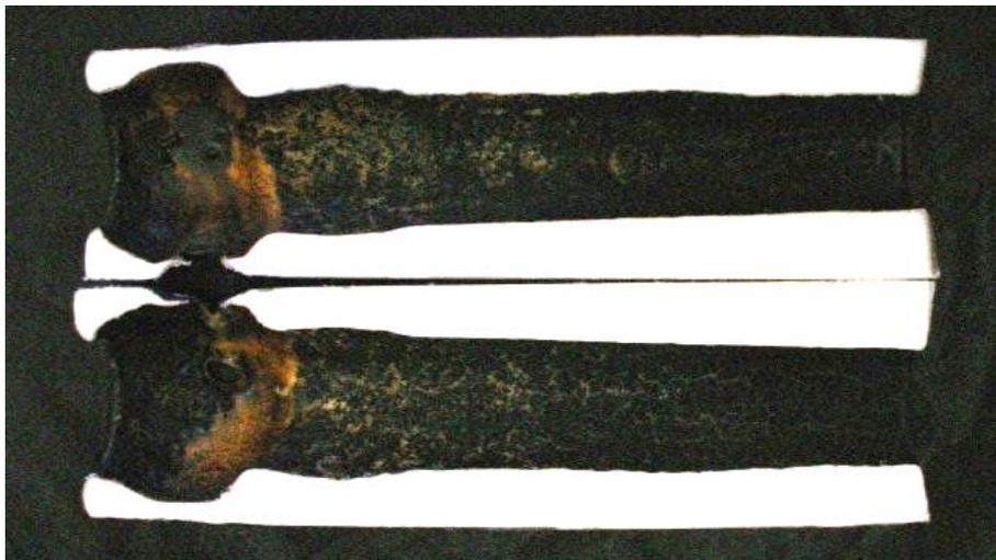
Figura 4.23 - Grão propelente queimado em corte.
