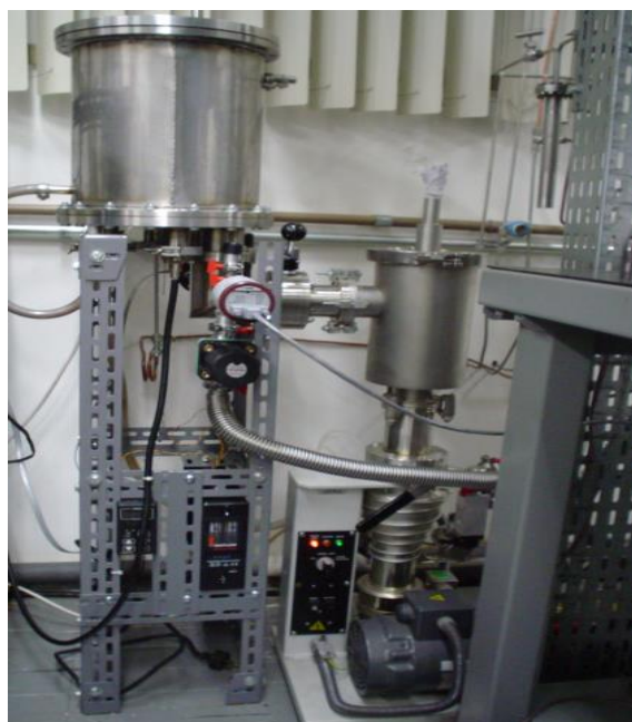
Figura 20 – Reator de plasma de oxigênio para funcionalização e esfoliação de nanotubos de carbono verticalmente alinhados.
