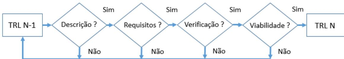
Figura 2.8- Fluxo do processo de avaliação TRL
