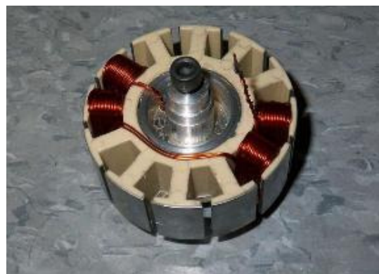
Figura 2.4 - Estator de um motor DC sem escovas.
