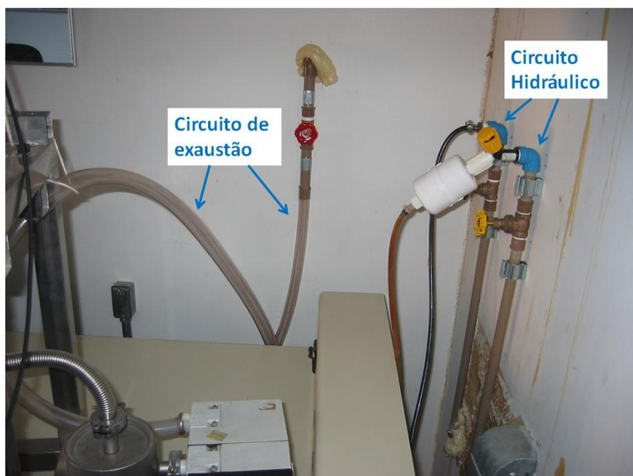
Figura 4.2 - Circuitos hidráulicos e de exaustão da sala de ensaios no prédio do BTSA/LCP
