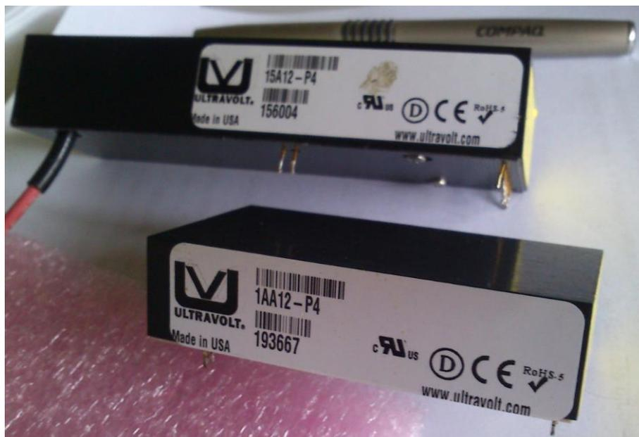
Figura 4.14 - Fontes Ultravolt originais do DD-PPT de 15 kV (superior) e 1 kV (inferior)
