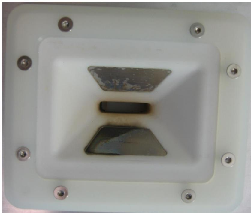
Figura 5.3 - Eletrodos secundários após ensaios
