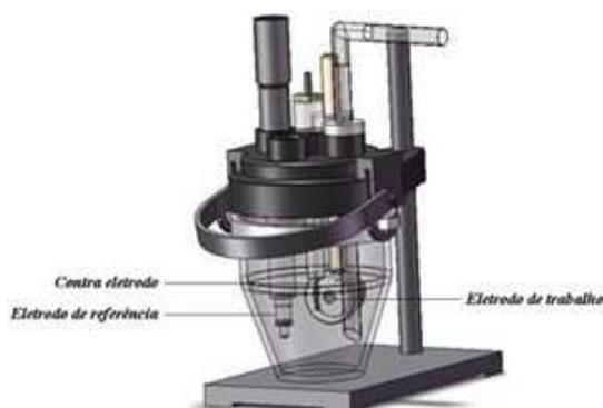
Figura 3.5: Célula eletroquímica
