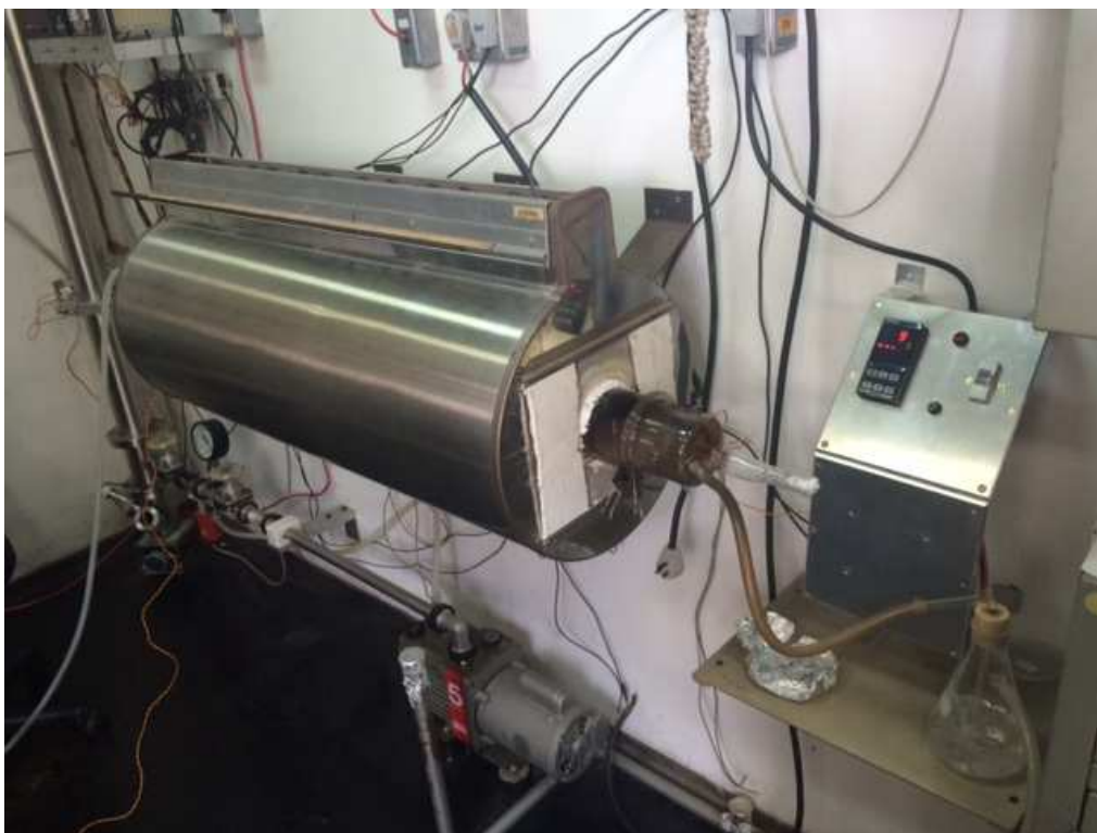
Figura 3.2: Forno tubular para tratamento térmico alocado no LAS/CTE/INPE.
