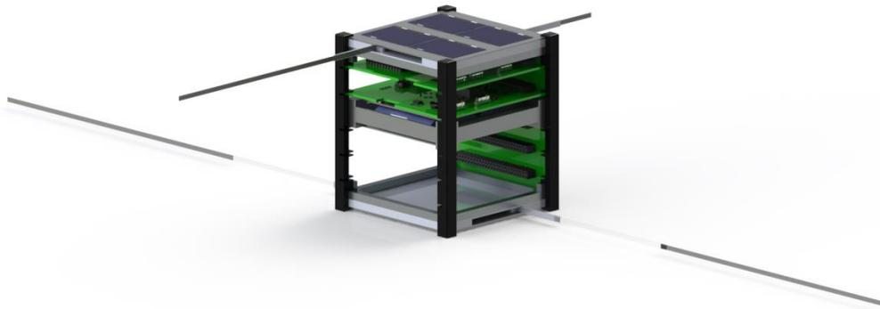
**Figura 23:** Estrutura Mecânica do AESP14.
