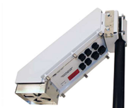
Figura 4.7 – Sensor Campbell CS110 com datalogger CR1000 acoplado.
