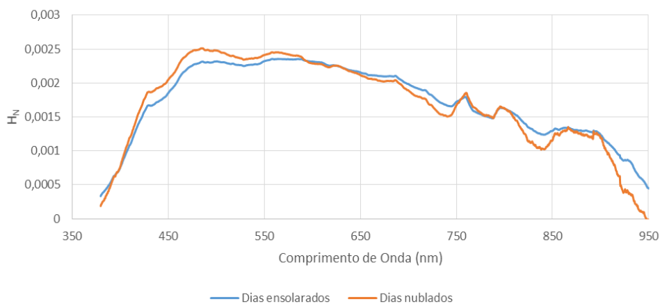
Figura 6 – Espectros normalizados médios da radiação solar coletados às 12:00 para condições de céu ensolarado e nublado para o mês de julho. As curvas foram tratadas com a técnica da Média Móvel afim de torná-las mais suave.
