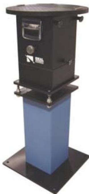
Também foi utilizada a câmara térmica Friocell, fabricada pelo MMM Group, capaz de levantar temperaturas de 0°C a +90°C; ela opera com histerese de  $\pm 0,2^\circ\text{C}$ . Na Figura 8.2 há uma foto da câmara térmica utilizada.
