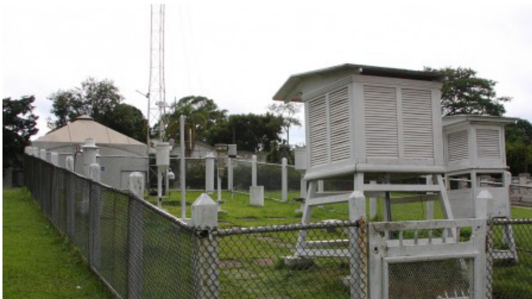
Figura 4.2 - Estação convencional de superfície.
