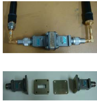
Fig. 4. (a) Vista parcial unificada; (b) o conjunto de e os adaptadores guia/cabo coaxial.
