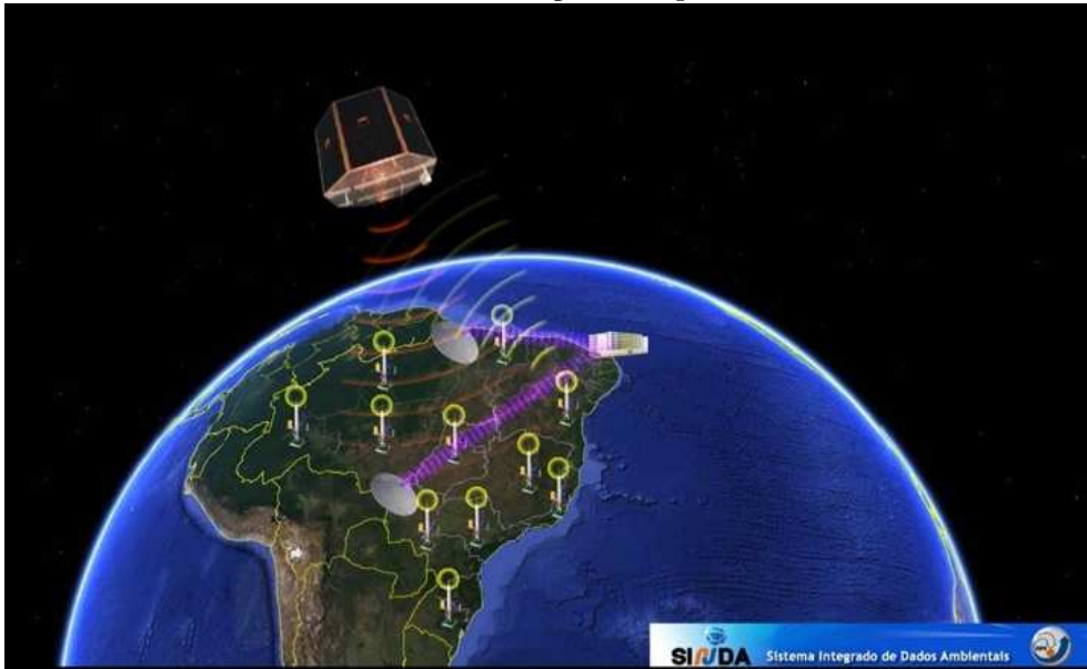
Figura 1.1 - Ilustração da configuração atual do SBCDA com comunicação entre as PCDs, um dos satélites SCDs e às estações receptoras retirada do site do SINDA.
