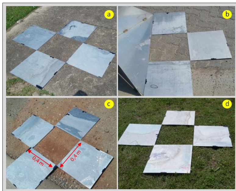
Figura 3.16 - Alvos analisados: a) calçada de concreto, b) bloquete de concreto, c) solo exposto e d) superfície com vegetação rasteira (grama).
