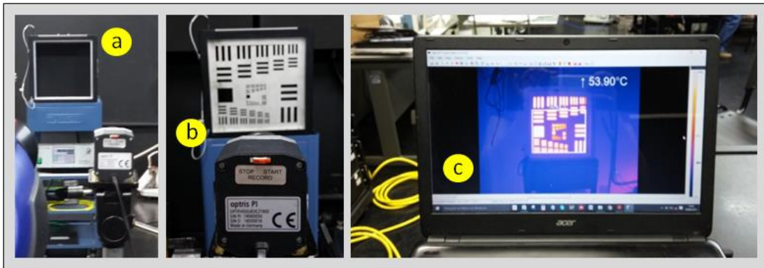
Figura 3.9 - a) Corpo Negro de Área Extensa, modelo SR800 da CI Systems; b) Corpo Negro com alvo padrão USAF 1951 acoplado, c) Visualização do software durante a realização da medida pelo sensor.
