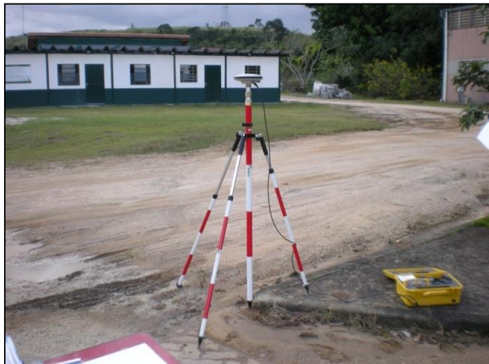
Figura 3.21 - Coleta de dados com GNSS para pontos de controle e checagem.
