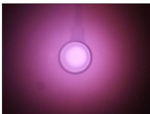
Figura 4.16 - Condição de confinamento do plasma de nitrogênio observada para o tubo T3, com campo magnético de 65 G.
