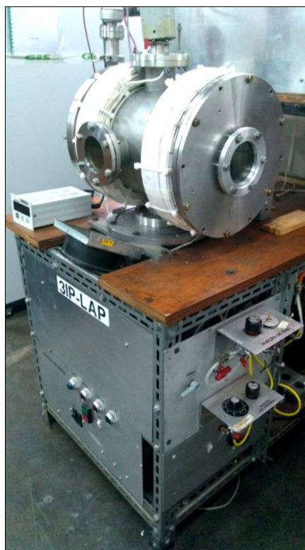
Figura 3.1 - Fotografia do sistema 3IP-LAP com bobinas magnéticas.
