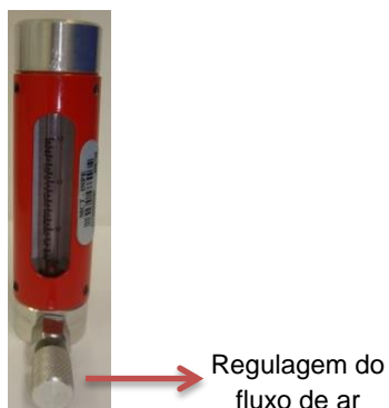
Figura 17 - Ponto de regulação no rotâmetro.
