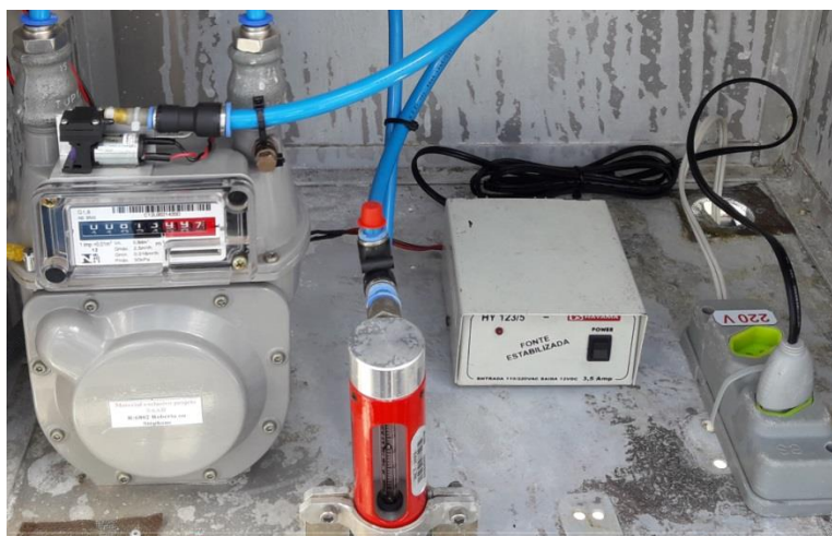
Figura 18 - Sistema alimentado pela fonte estabilizada.
