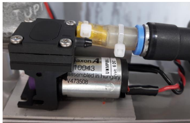
Figura 14 - Micro bomba conectada no sistema.
