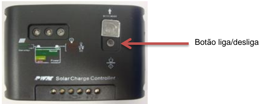
Figura 15 - Botão liga/desliga no controlador de carga solar.
