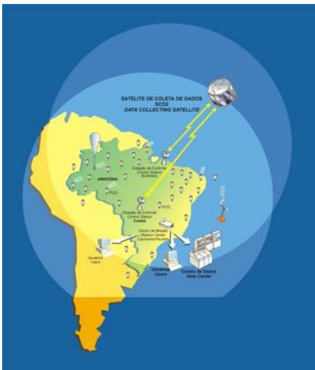
Figura 1.1 - SBCDA, mostrando os círculos de visibilidade das estações de Cuiabá e de Alcântara.
