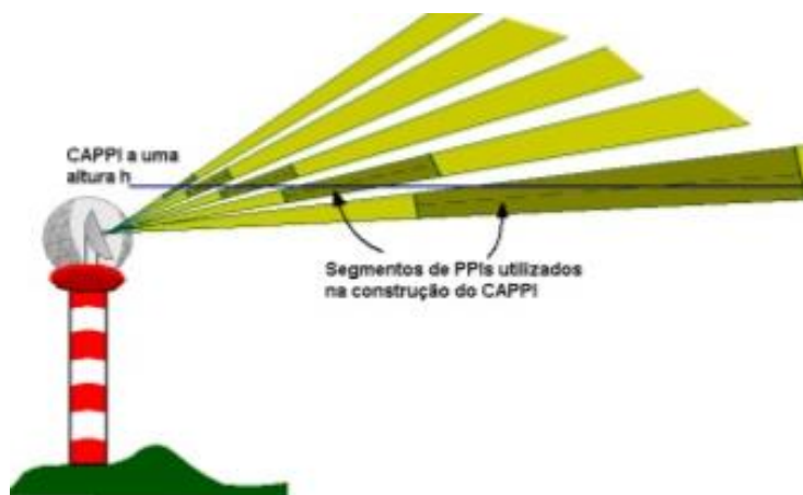
Figura 2.3 – Esquematização dos fragmentos de elevação utilizados para gerar uma imagem CAPPI.
