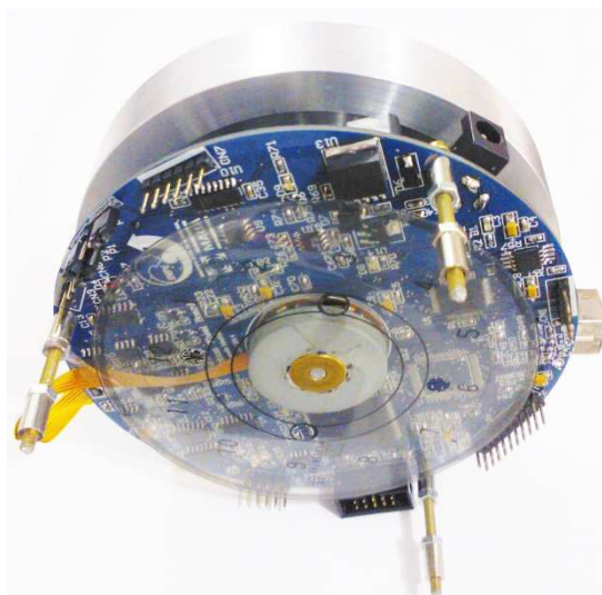
Figura 3.2 – Foto do controlador eletrônico finalizado acoplado ao volante de inércia pronto para os ensaios.
