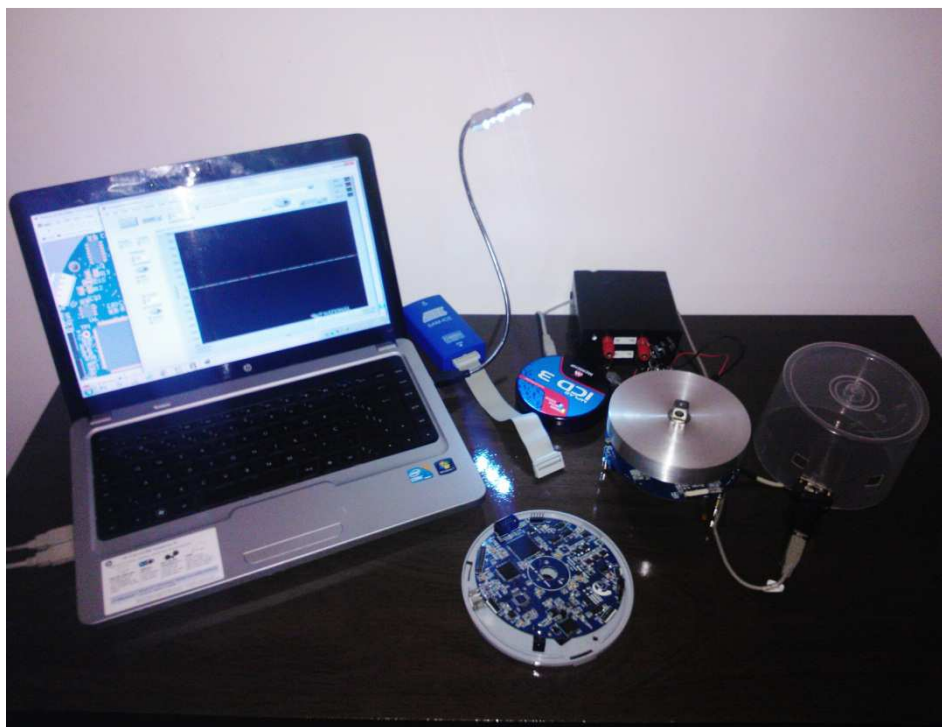
Figura 5.1 - Ambiente de validação. Software em Labview, conexões seriais e USB e fonte de alimentação.
