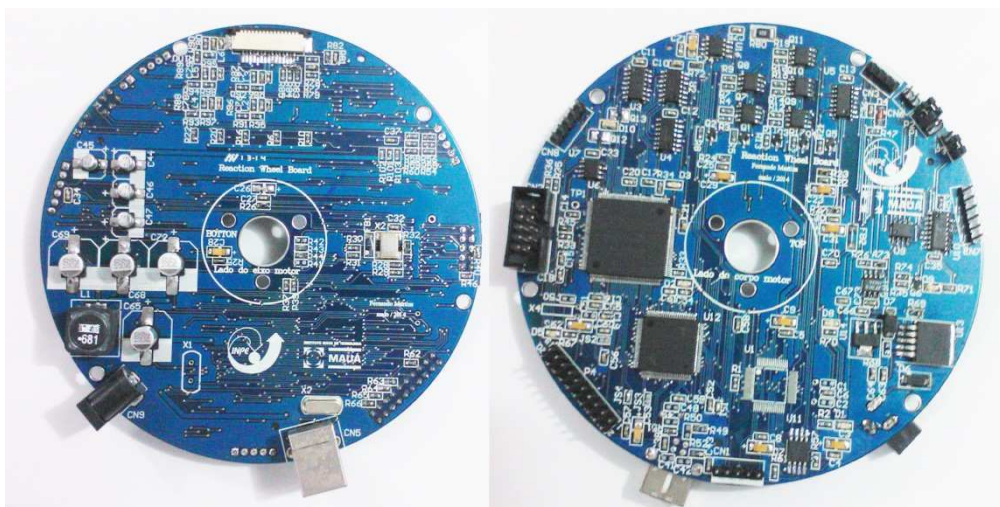
Figura 3.1. - Foto da placa controladora montada. Na esquerda mostra-se o detalhe da fonte de alimentação e do conector do motor. Na direita aparece o circuito de acionamento e de processamento.
