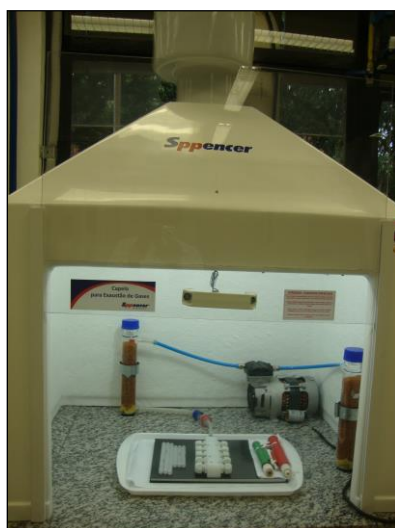
Figura 5: Sistema de secagem montado na capela (Foto: Crispim S.P., 2013)
