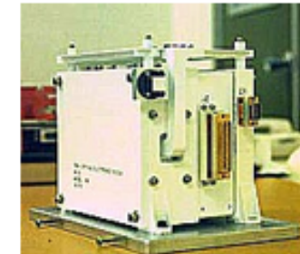
A cabeça óptica do WFI
