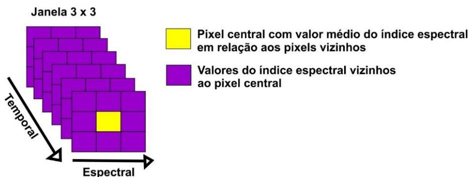
Figura 2.4 - Esquema ilustrativo da janela de kernel (3 x 3 pixels) para cada pixel da série temporal de imagens Landsat.
