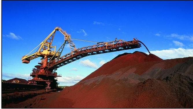
Figura 2.6 - Sistema de empilhadeira em correia transportadora.
