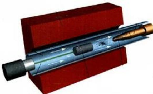
Um tubo de quartzo preenchido com gás inerte e contendo o alvo de grafite que é atingido pelo feixe de laser. Ao ser varrido pelo laser o alvo libera uma nuvem de partículas de carbono que são capturadas pelo coletor de cobre, onde são formados os CNTs.
