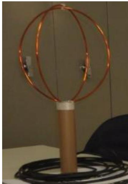
Antena tipo *Eggbeater* utilizada na estação, em processo de desenvolvimento.
