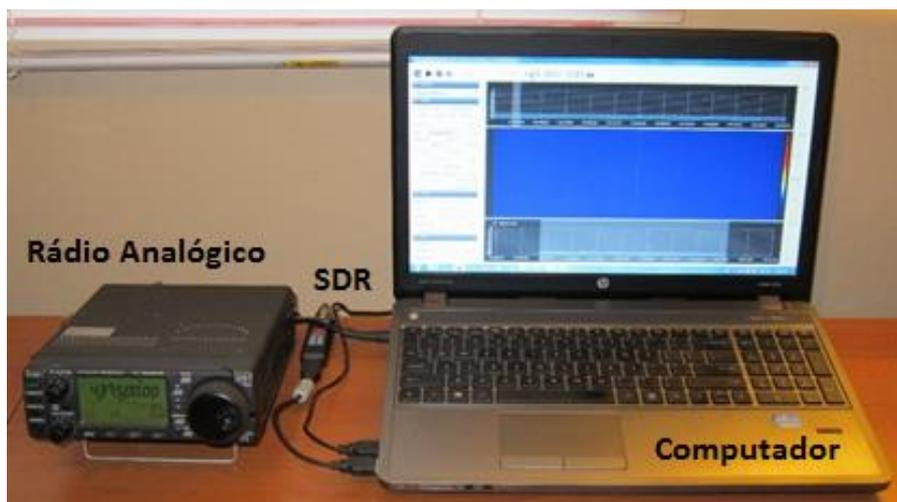
A estação possui quatro componentes em *hardware*: três apresentados na Figura 3.14, e o conjunto das antenas no exterior do local de operação
