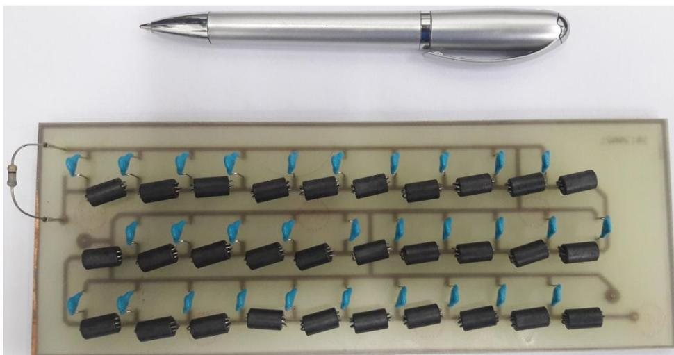
Figura 4.98- LTNL Híbrida#1 montada em uma placa de circuito impresso.
