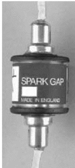
Figura 3.27- Imagem do *spark gap* utilizado para chaveamento na LTNL usado como PFN.
