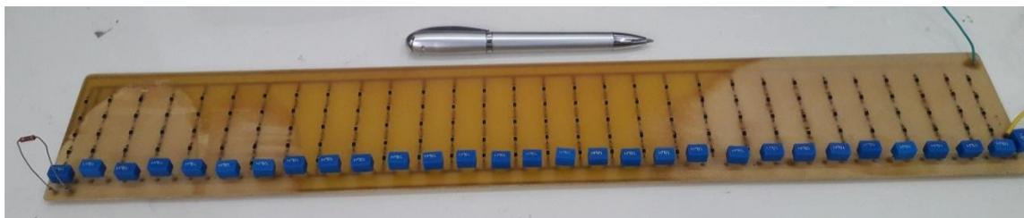
Figura 4.37- LTNL-MP#5 construída com varactores em série para geração de sóliton em média potência.
