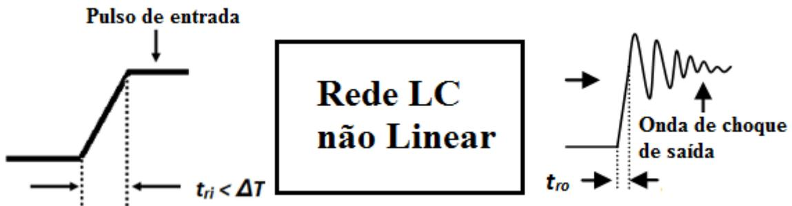
Figura 1.2- Processo de geração de onda de soliton em uma LTNL [12].
