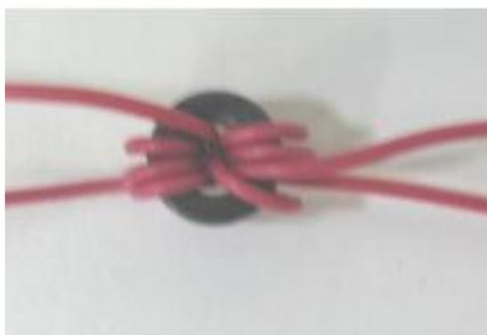
Figura 3.4- Enrolamento em um toróide à base de ferrita.
