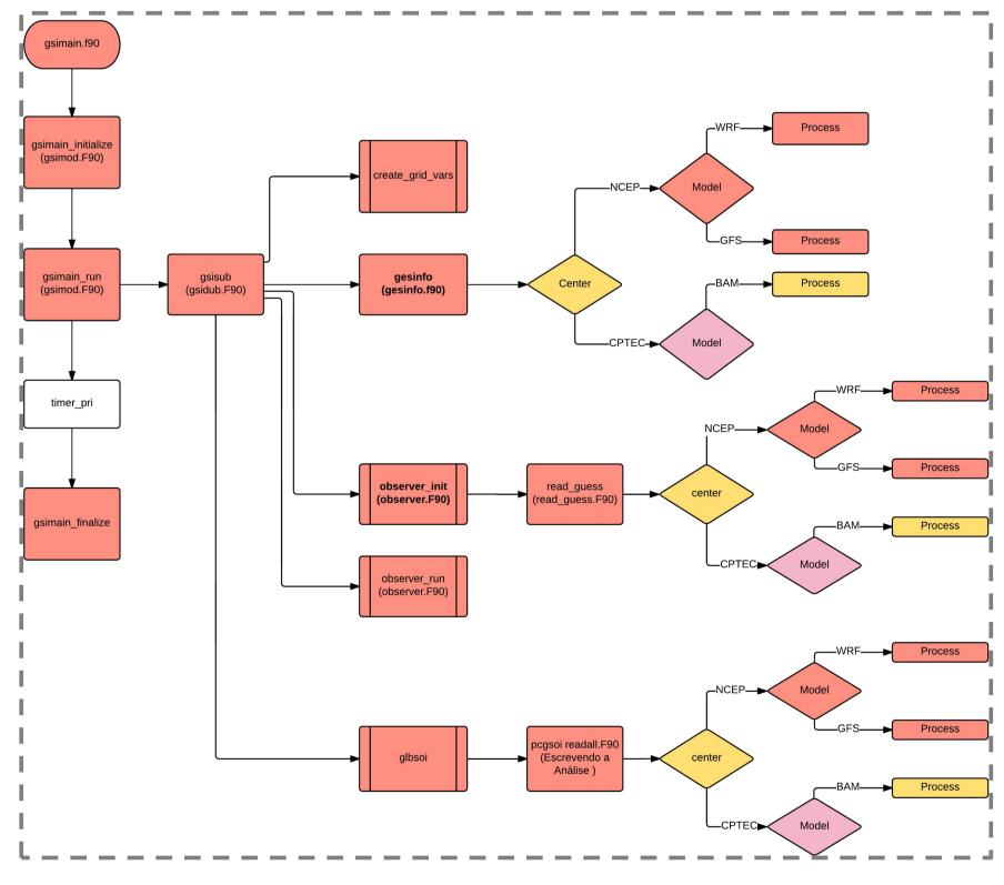
**Figura 6.** Fluxograma das alterações realizadas no GSI.
