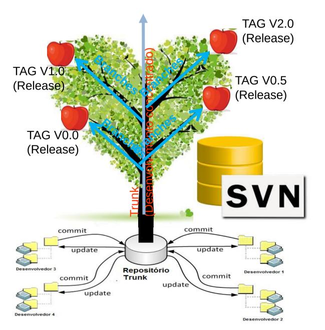
Figura 1. Sistema de Versionamento do código SVN onde o desenvolvimento e feito de forma compartilhada e otimizada.
