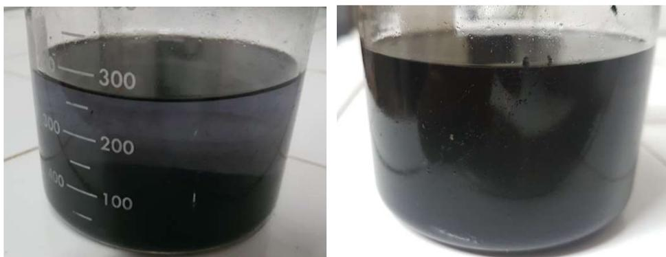
Imagem da esquerda: mistura sem centrifugação onde pode-se observar as partículas de negro de fumo. Imagem da direita: mistura homogênea devida à centrifugação. Fonte: Produção do autor.
