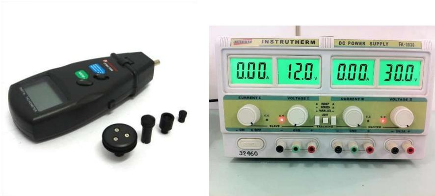
Imagem da esquerda: tacômetro digital. Imagem da direita: fonte elétrica para controle da velocidade de centrifugação.
