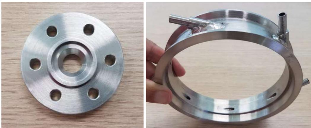
Esquerda: tubeira do propulsor. Direita: corpo central e sistema de injeção.
