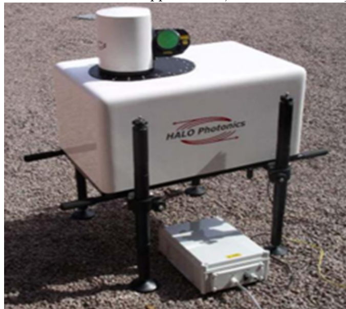
Figura 3.7 - Instrumento Doppler Lidar , instalado na estação T3.
