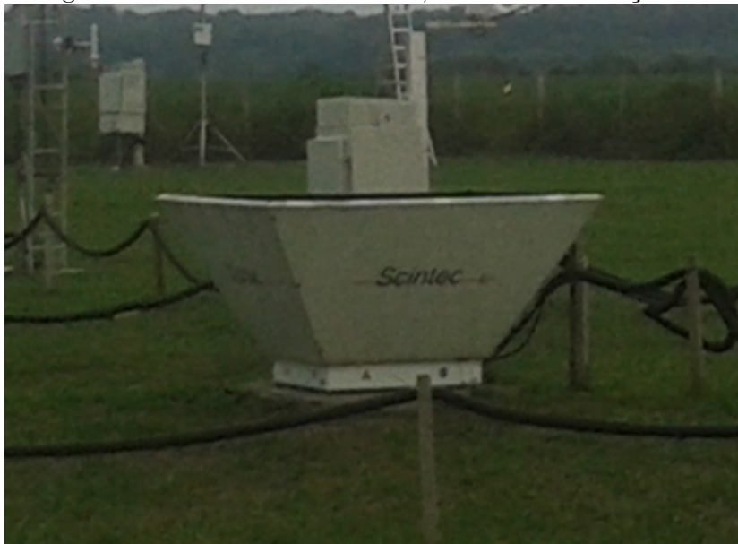
Figura 3.4 - Instrumento SODAR, instalado na estação T3.
