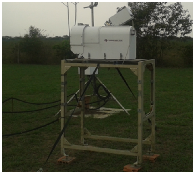
Figura 3.6 - Instrumento Microwave Radiometer Profiler (MWR), instalado na estação T3.
