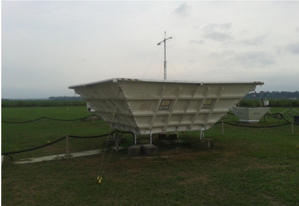
Figura 3.3 - Instrumento Radar Wind Profiler and RASS, instalado na estação T3.
