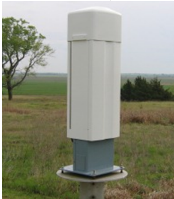
Figura 3.5 - Instrumento Ceilometer , instalado na estação T3.
