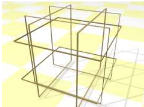
Figura 1. Conjunto de bobinas de Helmholtz com formato cúbico
