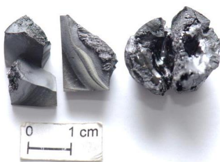
Figura 4.71 – Alvo cerâmico da composição 14,5 MBP sinterizado ao ar, após incidência do feixe de elétrons.
