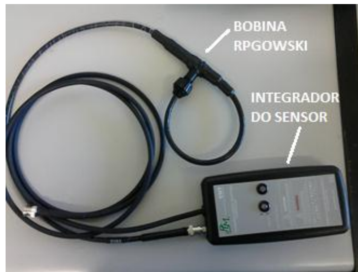
Figura 38: Sensor de corrente do tipo bobina Rogowski.
