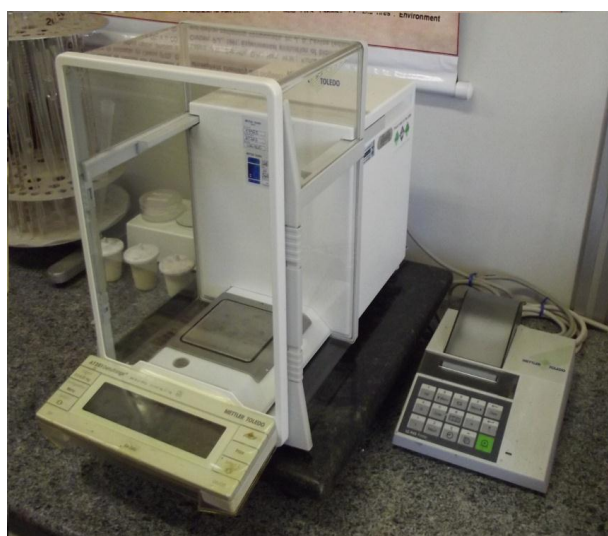
Figura 34- Balança de precisão utilizada nos testes.
