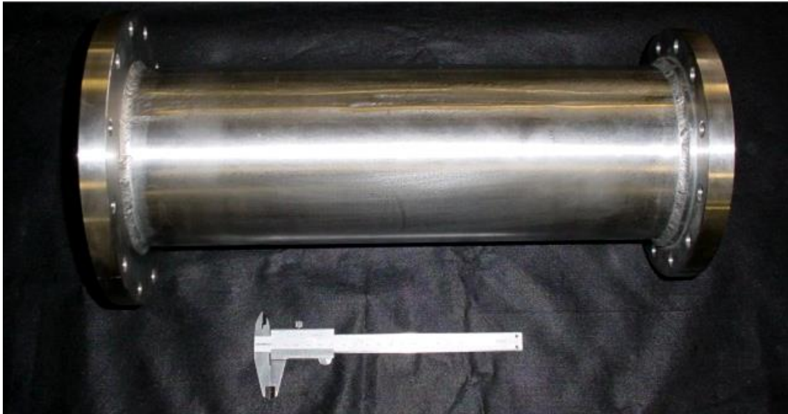
Figura3.4 -Câmara de combustão.
