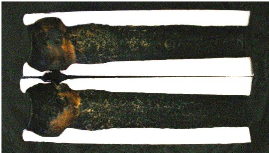
Figura 4.23 - Grão propelente queimado em corte.
