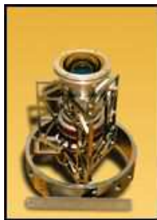
Figura 1.6 – Foto do sensor LIS que está a bordo do TRMM.
