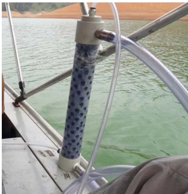
Figura 4.3: Tubo equilibrador utilizado nos trabalhos de campo.
