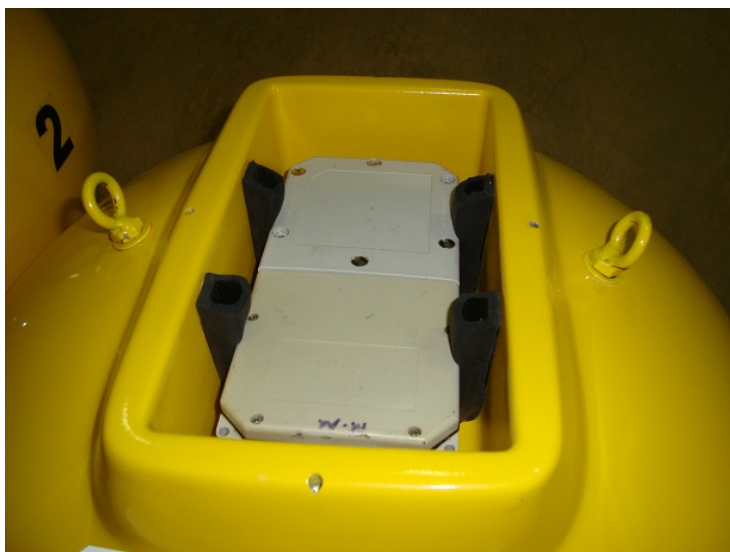
Figura 4.7: Compartimento superior de armazenamento do equipamento SmartOne GlobalStar© utilizado para localização e segurança das cadeias.
