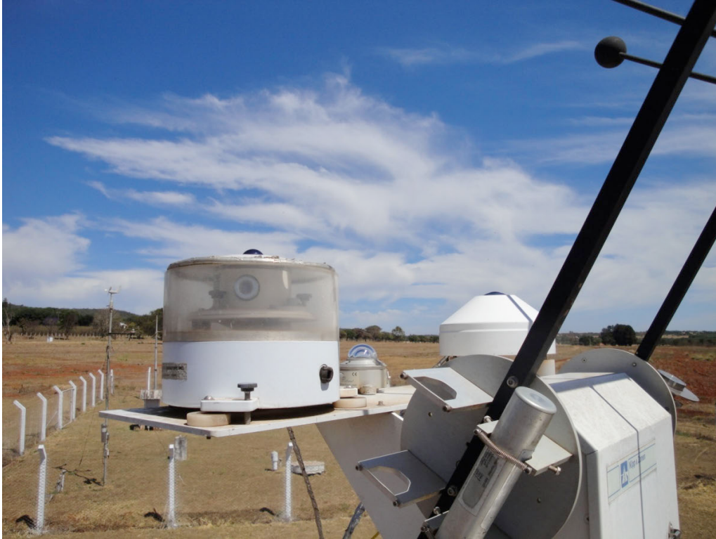
Figura 3.12 - Experimento de coleta de dados destinados à avaliação dos dados de ROL de Brasília. Os sensores PIR (analisado), Piranômetro e CG4R 120512 (referência para campo) estão dispostos da esquerda para a direita.
