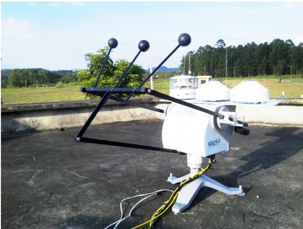
Figura 3.1 - Experimento de coleta de dados destinados à avaliação da metodologia. Da esquerda para direita ver-se os sensores PIR (analisado), CG4 (padrão) e CGR4 (analisado).
