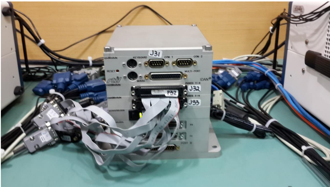
Figura 5.5. Computador de Bordo com arquitetura x86
